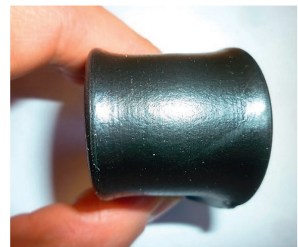
Bild 4. Mit dem Planetwalzenextruder aufbereitetes Gummi-Bitumen-Compound © Entex
